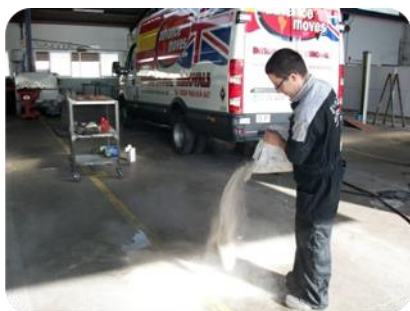
Tratamiento de derrame mediante aplicación de sepiolita (absorbente)
